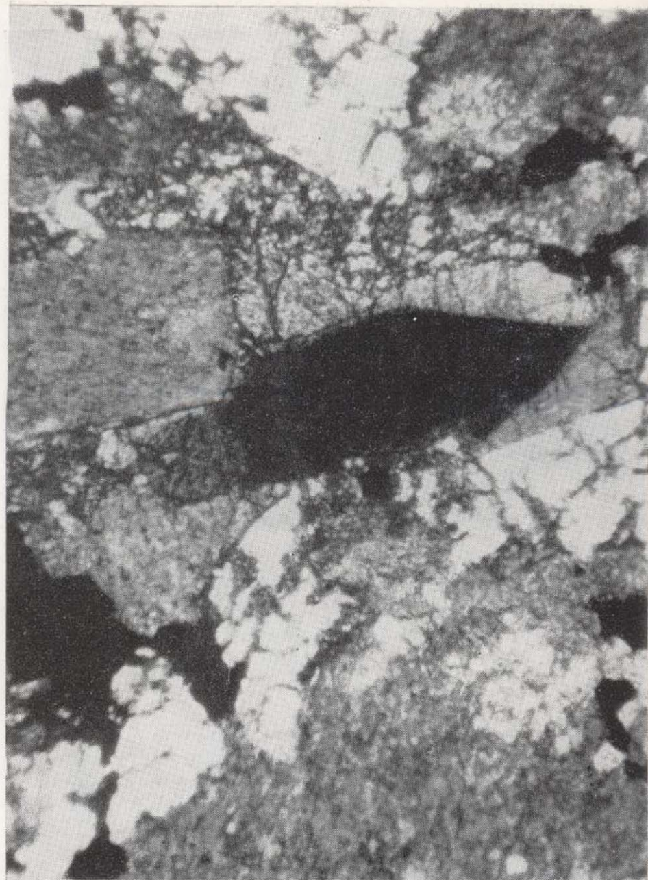
Foto 7.—Secciones con núcleo de alanita y periferia de epidota en una formación de skarn. Sondeo 36. 136,60 metros. N // ( \times 50 .)
