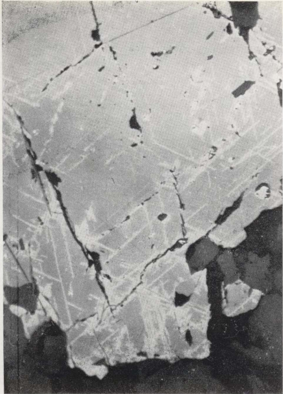
Foto 17.—Incipiente martitización de magnetita según planos (111) de crucero octaédrico. Probeta pulida. N // ( \times 200 ).
